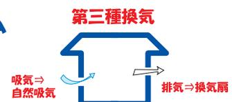
全ての居室の壁に給気口を設け空気を自然換気で流入させる。取り込まれた空気は室内を循環し、排気口部分に設置された排気ファンによって強制的に室外に空気が排気されるシステムです。
